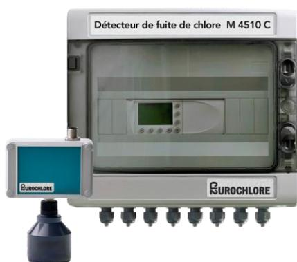
Le chlore est un gaz largement utilisé comme désinfectant, et dont la toxicité est importante (VLE de 1,5mg/m<sup>3</sup>). **Le détecteur de chlore est l'organe de sécurité fondamental des locaux de stockage** et d'utilisation du chlore gazeux car il permet d'**identifier** les fuites de chlore, d'**alerter** et de **déclencher** les mesures de protection des personnes et de l'environnement.
